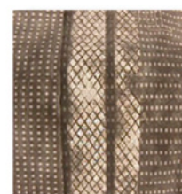
Costuras termosoldadas por ultrasonido Topguard®.
